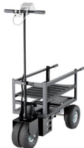
電動コンパクト作業車。狭い畝に最適な横幅 40cm 三輪
