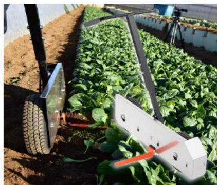
ハウレンソウ刈機。走らせるだけで葉物野菜の根を一気にカット
